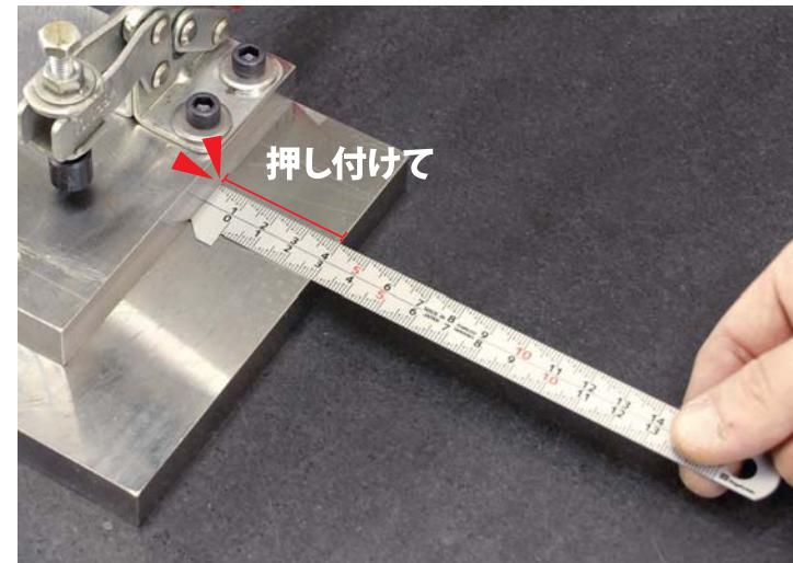
■用途 端面からの寸法測定、C面取の簡易測定
